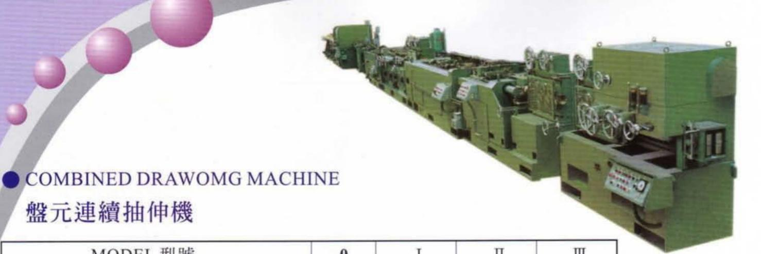
MODEL 型號  $\mathbf{III}$ FINISH SIZE(Ø mm) 成品尺寸 19-32 5-13 10-20 4-8 ●ROUND BAR 圓棒 4-7 5-12 10-20 19-30 ■SQUAREBAR 方棒 19-32 ●HEXAGON BAR 六角棒 5-13 10-20 4-8 2.0-6.0 CUTTING ENGTH(m) 裁斷長度(米) 2.0-6.0 2.0-6.0 2.0 - 4.0MAX. DRAWING SPEED(m/min) 45 80 60 60 最高拉伸速度(米/分)
